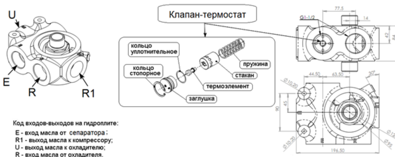
Рисунок 15 – Гидроплита и клапан-термостат
