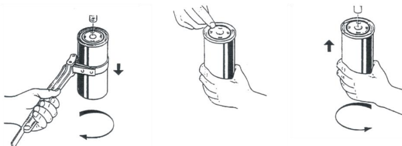
Рисунок 22 – Последовательность операций при замене фильтра масляного
