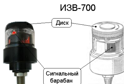
Рисунок 8 – Индикаторы засоренности воздухоочистителей
