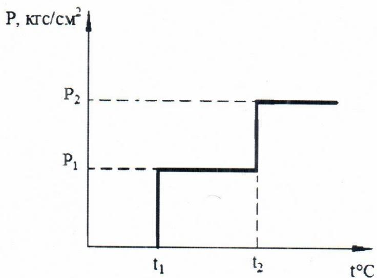
$t_1^*$  - минимальная температура воздуха, при которой допускается пуск сосуда и аппарата для работы под давлением  $P_1$  в соответствии с обязательными приложениями ГОСТ 34347-2017г.
